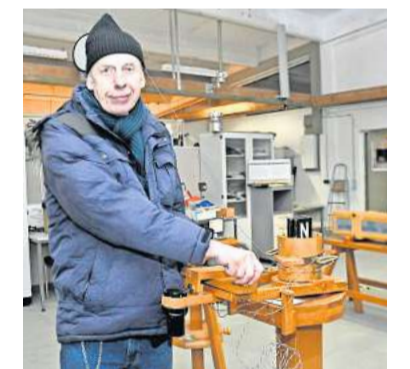
Der Vereinsvorsitzende Friedrich Vehrenkamp betätigt einen Gauß-Weber-Telegraphen. Das Gerät wurde 1833 von Carl Friedrich Gauß und Wilhelm Eduard Weber erfunden und war seinerzeit der erste elektromagnetische Telegraf der Welt.
